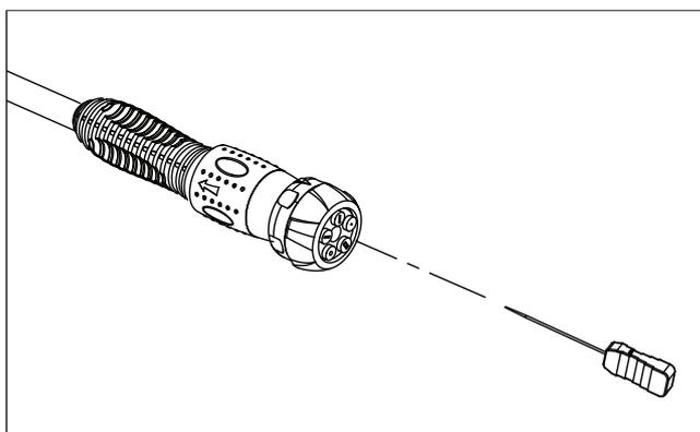
L'obstruction de la buse peut entraîner une pression trop élevée. Dans un tel cas, nettoyez-la immédiatement. Vous pouvez nettoyer la buse en insérant délicatement l'aiguille de nettoyage ou un instrument mince et pointu (ex. : un trombone) dans la buse obstruée pour déloger les dépôts.
