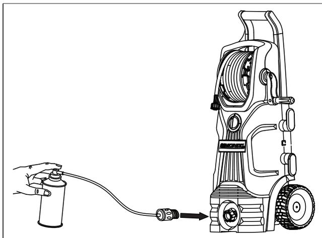
1. Raccordez le tuyau d'antigel à l'adaptateur de l'entrée.
