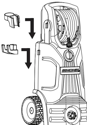
Assemblez le support de bouteille et le support de pistolet.
