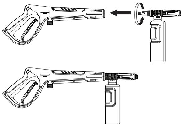
1. Fixez la buse avec bouteille à détergent au pistolet.
