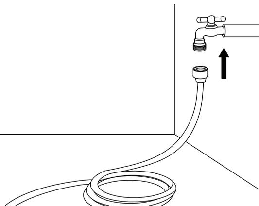
Raccordez le tuyau d'arrosage à l'alimentation en eau et ouvrez la valve.
