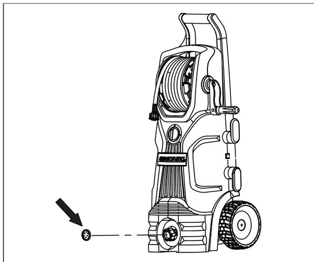
Le pulvérisateur haute pression est doté d'un filtre d'entrée d'eau munie d'un filtre pour protéger la pompe. Gardez le filtre propre pour éviter de diminuer le débit d'eau au pulvérisateur et d'endommager la pompe.
