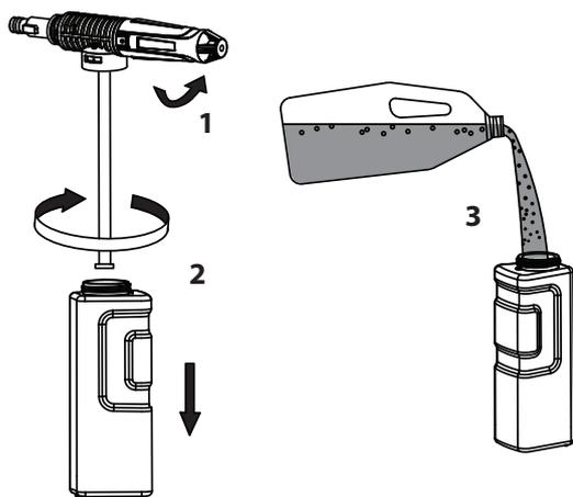
1. Faites tourner la tête de pulvérisation d'une position verticale à une position horizontale.
