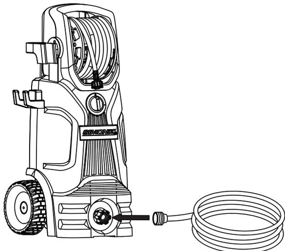
Raccordez le tuyau d'arrosage à l'adaptateur d'entrée.
