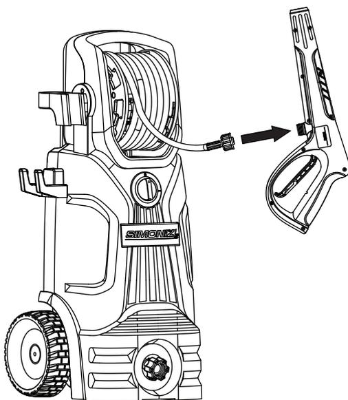
Raccordez le tuyau haute pression au pistolet (serrez-le à la main seulement).
