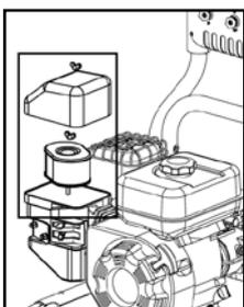
Dévissez l'écrou à oreilles à la main et enlevez le couvercle du filtre à air. Dévissez l'autre écrou à oreilles, puis retirez soigneusement le filtre à air. Lavez-le à l'eau claire, trempez-le dans l'huile moteur vierge et exprimez-en l'excès. Réinstallez le filtre à air et le couvercle.
