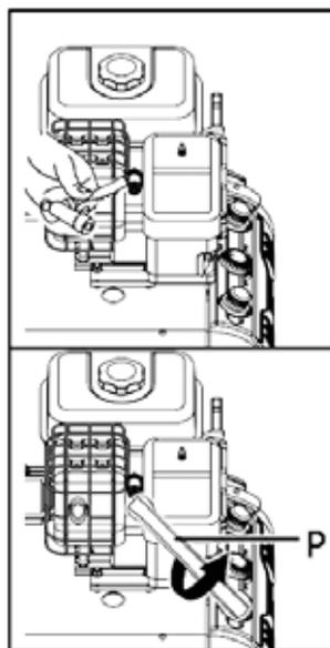
3. Vérifiez l'écartement des électrodes avec une jauge. Si nécessaire, réglez l'écart entre 0,7 et 0,8 mm. Réinstallez la bougie et serrez-la au couple prescrit de 20 Nm (180 lb-po).
