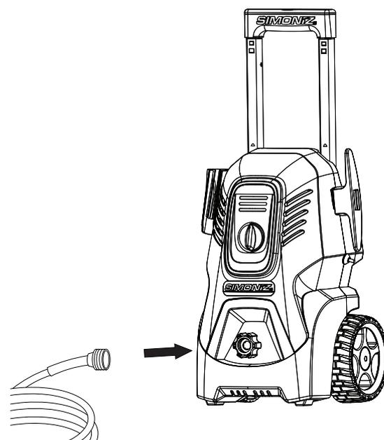
Raccordez le boyau d'arrosage à l'adaptateur d'orifice d'admission.
