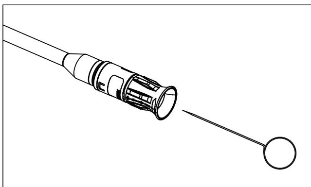
L'obstruction des buses peut entraîner une pression trop élevée dans la pompe, et il faut alors les nettoyer immédiatement. Vous pouvez nettoyer les buses en insérant doucement une aiguille (G), ou un objet mince et pointu comme un trombone, dans le bout pour déloger les dépôts.
