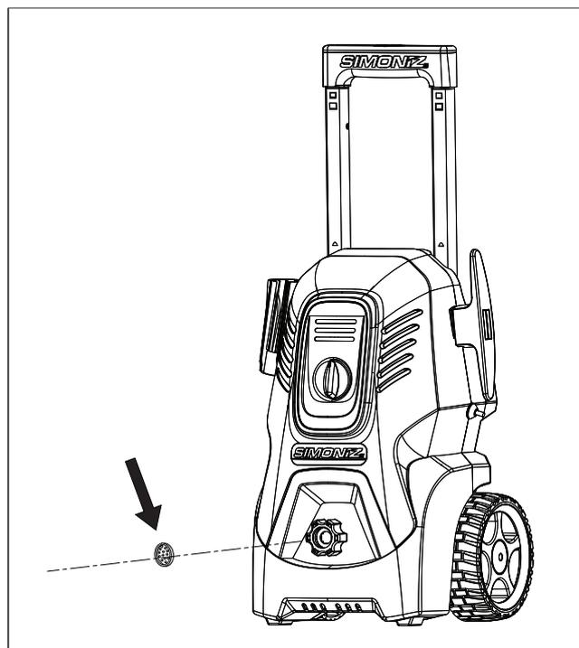
Le pulvérisateur haute pression est muni d'un filtre d'entrée d'eau pour protéger la pompe. Gardez le filtre propre pour prévenir la réduction du débit d'eau du pulvérisateur haute pression et les dommages à la pompe.
