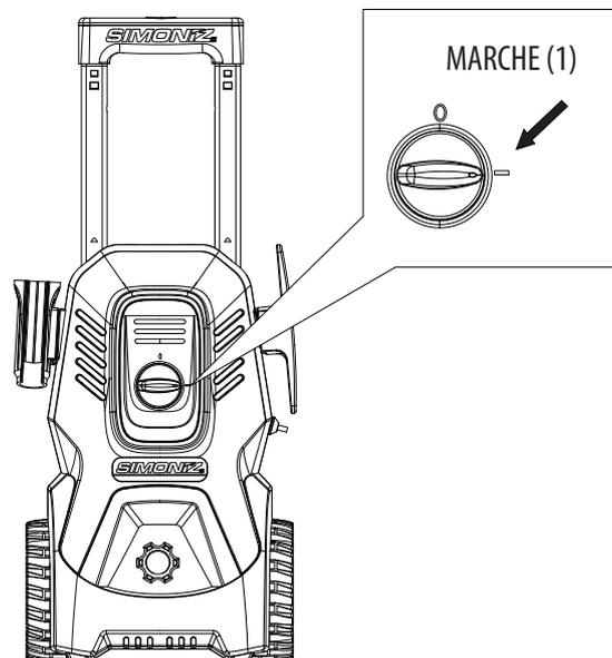
Mettez l'interrupteur principal à la position **MARCHE** et le pulvérisateur électrique est prêt à être utilisé.
