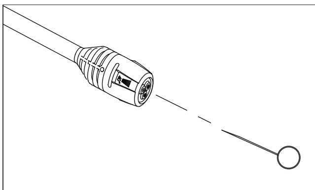
L'obstruction des buses peut entraîner une pression trop élevée dans la pompe, et il faut alors les nettoyer immédiatement. Vous pouvez nettoyer les buses en insérant doucement une aiguille (H), ou un objet mince et pointu comme un trombone, dans le bout pour déloger les dépôts.
