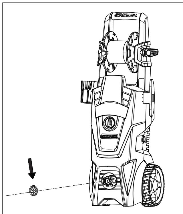
Le pulvérisateur haute pression est muni d'un filtre d'entrée d'eau pour protéger la pompe. Gardez le filtre propre pour prévenir la réduction du débit d'eau du pulvérisateur haute pression et les dommages à la pompe.
