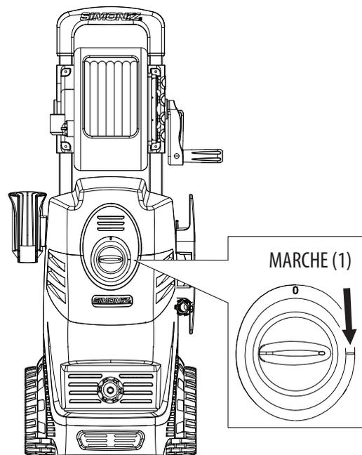
Mettez l'interrupteur principal à la position **MARCHÉ** et le pulvérisateur électrique est prêts à être utilisé.
