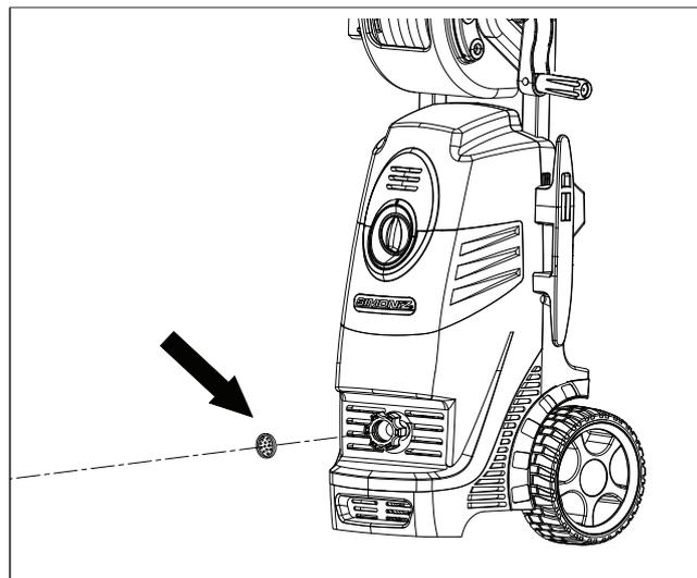
Le pulvérisateur haute pression est muni d'un filtre d'entrée d'eau pour protéger la pompe. Gardez le filtre propre pour prévenir la réduction du débit d'eau du pulvérisateur haute pression et les dommages à la pompe.
