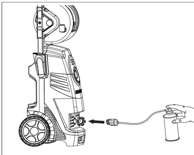
1. Raccordez le boyau du contenant d'antigel à l'adaptateur d'orifice d'admission.
