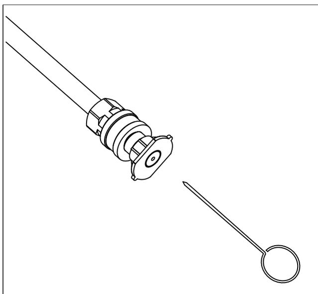
L'obstruction des buses peut entraîner une pression trop élevée dans la pompe, et il faut alors les nettoyer immédiatement. Vous pouvez nettoyer les buses en insérant doucement une aiguille (K), ou un objet mince et pointu comme un trombone, dans le bout pour déloger les dépôts.
