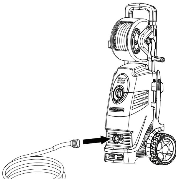
Raccordez le boyau d'arrosage à l'adaptateur d'orifice d'admission.
