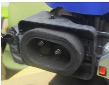
**ÉTAPE 5 :** Mettez le filtre d'air nettoyé, ou neuf, en place, et retournez le couvercle et l'écrou d'ailettes.
