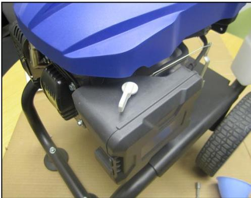
**ÉTAPE 1 :** Le carburateur est situé derrière le filtre d'air. Retirez le filtre d'air pour accéder le carburateur.
