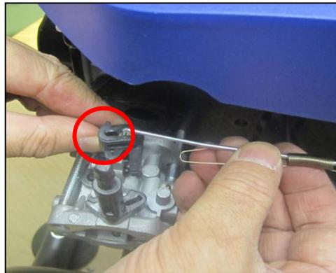
**ÉTAPE 6 :** Décrochez le fil de gaz et le ressort de tension.
