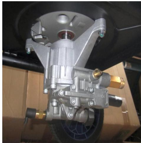
**ÉTAPE 2:** Utilisez une clé pour retirer la soupape d'injection de détergent située sous l'assemblage de la pompe. Prenons garde à ne pas perdre la petite balle et le ressort situés à l'intérieur de l'injecteur de détergent.
