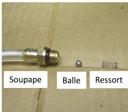
**ÉTAPE 3:** Dévissez et retirez la soupape d'injection de détergent. Débranchez le tube de la soupape et insérez la nouvelle soupape. Remplacez le nouvel injecteur de détergent en plaçant le ressort et la balle dans l'injecteur comme indiqué dans cette image. La balle doit être maintenue en place avec le ressort.
