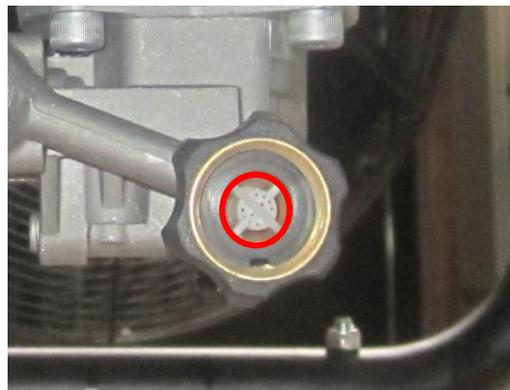
**ÉTAPE 1 :** À l'aide d'une pince à bec, saisissez fermement le filtre d'eau en plastique situé à l'intérieur de l'entrée d'eau et retirez le filtre d'eau.
