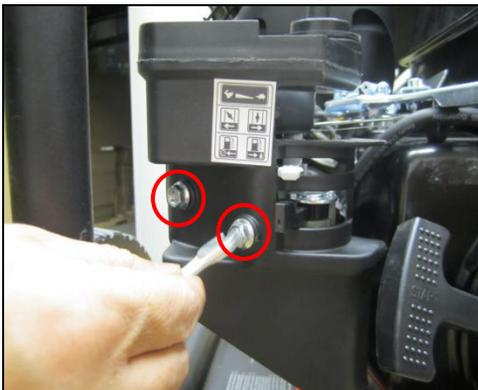
**ÉTAPE 3:** À l'aide d'une clé métrique # 10, retirez les deux écrous qui maintiennent le couvercle du carburateur, et desserrez le couvercle, mais ne les détachez pas.
