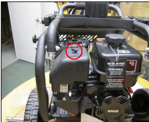
**ÉTAPE 1:** Dévissez l'écrou à ailettes en sécurisant le couvercle du filtre d'air. Retirez la couverture.
