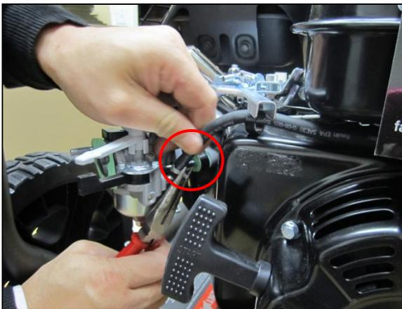
**ÉTAPE 7 :** Utilisez une pince à bec pour desserrer la pince sur la ligne de gaz et détacher la conduite de gaz du carbureteur en la retirant tout en serrant la pince.
