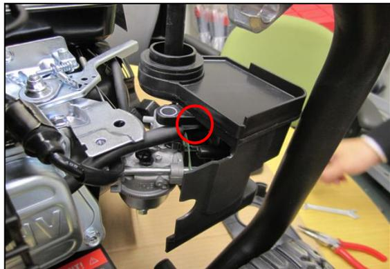
**ÉTAPE 4:** Débranchez le tuyau en caoutchouc du filtre d'air de l'arrière du couvercle.
