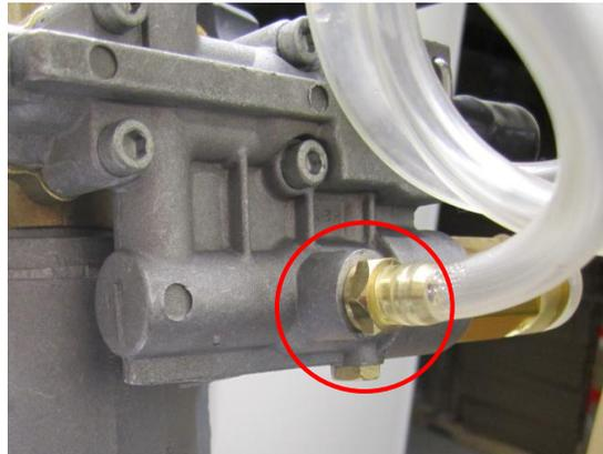
**ÉTAPE 2:** Utilisez une clé pour retirer la soupape d'injection de détergent située sous l'assemblage de la pompe. (Ci-dessus photo prise ci-dessous). Attention de ne pas perdre la petite balle retenue par la soupape d'injection de détergent.
