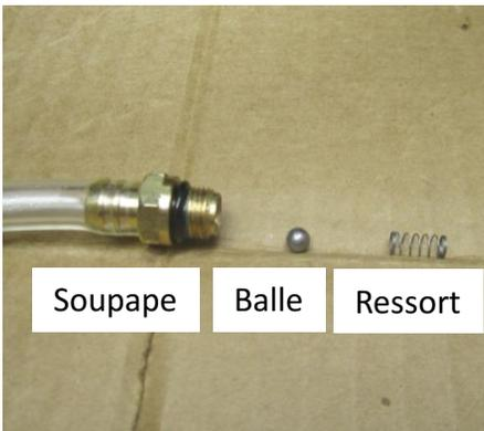
**ÉTAPE 3:** Dévissez et retirez la soupape d'injection de détergent. Débranchez le tube de la soupape et insérez la nouvelle soupape. Remplacez le nouvel injecteur de détergent en plaçant le ressort et la balle dans l'injecteur comme indiqué dans cette image. La balle doit être maintenue en place avec le ressort.
