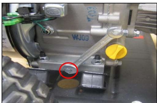
**ÉTAPE 3 :** À l'aide d'une clé, retirez le bouchon de vidange d'huile et laissez l'huile s'écouler. Après l'écroulement, retournez le bouchon de vidange d'huile et serrez fermement.
