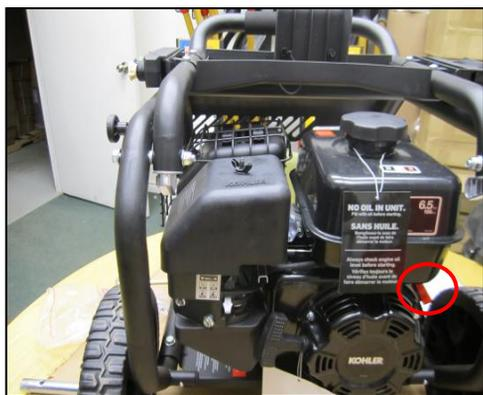
**ÉTAPE 1 :** Laissez le moteur en marche pendant une minute afin que l'huile chauffe et s'écoule plus librement.
