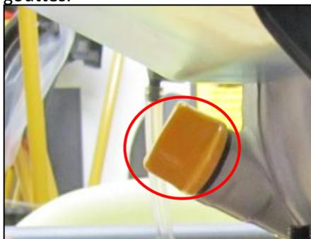
**ÉTAPE 4 :** Retirez la jauge. Utilisez un entonnoir pour remplir le carter avec de l'huile nouvelle jusqu'au goulot de remplissage. Le niveau d'huile devrait être au sommet de l'indicateur sur la jauge de niveau. Réinstallez le bouchon de remplissage d'huile / jauge et serrez solidement.
