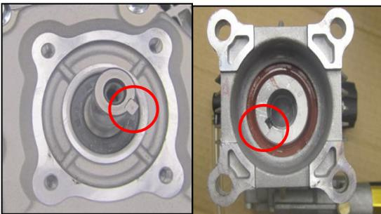
**ÉTAPE 3:** Lorsque vous glissez la nouvelle pompe sur l'arbre d'entraînement, alignez la rainure du moyeu de la pompe avec la rainure de l'arbre d'entraînement. Assemblez les quatre boulons à l'aide de la clé M13, mais ne serrez pas.
