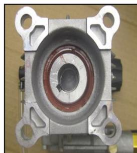
**ÉTAPE 4: IMPORTANT:** Avant de serrer les boulons, tournez le moteur en tirant doucement sur le cordon de démarrage une fois. Vissez les boulons dans un motif d'étoile pour répartir uniformément le stress. Serrez chaque boulon partiellement, puis passez à l'autre. Continuez dans un motif en étoile jusqu'à ce qu'ils soient tous serrés.
