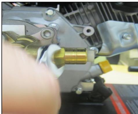
**ÉTAPE 2:** Utilisez une clé pour retirer la soupape de décharge thermique en le tournant dans le sens inverse des aiguilles d'une montre. Remplacez-le par une nouvelle soupape de décharge thermique et remettez-le capuchon en caoutchouc.
