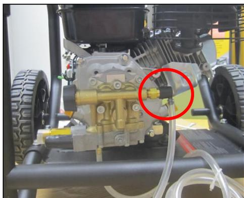
**ÉTAPE 1 :** Retirez le capuchon en caoutchouc de la soupape de décharge thermique et glissez-le à la main.
