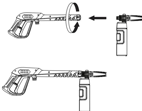
1. Fixez la buse avec bouteille à détergent au pistolet.
