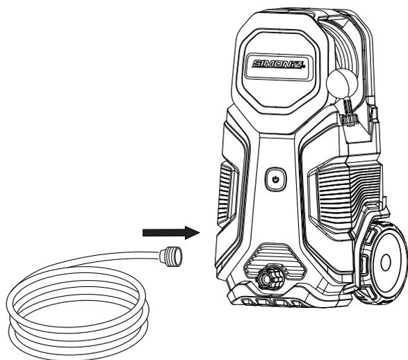
Raccordez le tuyau d'arrosage à l'adaptateur d'entrée.
