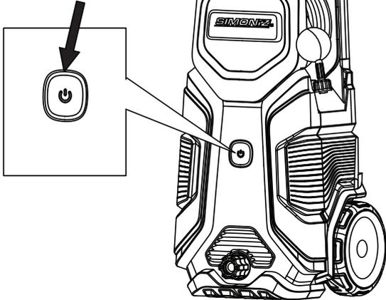
Appuyez sur l'interrupteur MARCHE/ARRÊT. Le voyant à DEL devient rouge et l'appareil est prêt à être utilisé. Appuyez sur l'interrupteur MARCHE/ARRÊT pour activer le mode d'ARRÊT.
