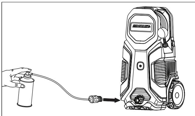
1. Raccordez le tuyau d'antigel à l'adaptateur de l'entrée.
