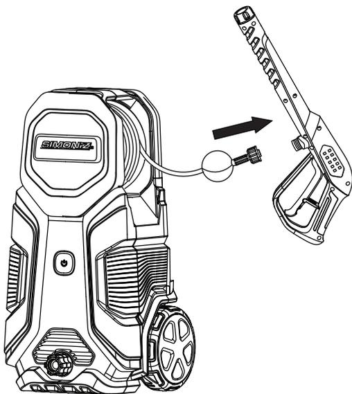
Raccordez le tuyau haute pression au pistolet (serrez-le à la main seulement).
