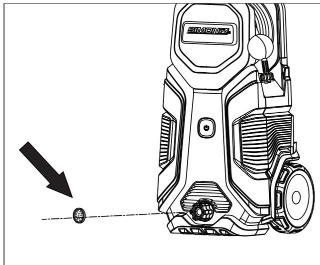
Le pulvérisateur haute pression est doté d'un filtre d'entrée d'eau (C) munie d'un filtre pour protéger la pompe. Gardez le filtre propre pour éviter de diminuer le débit d'eau au pulvérisateur et d'endommager la pompe.
