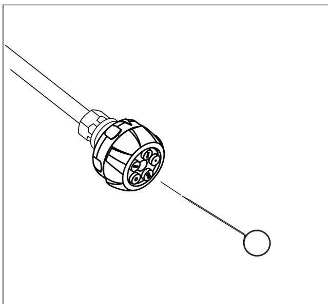
L'obstruction de la buse peut entraîner une pression trop élevée. Dans un tel cas, nettoyez-la immédiatement. Vous pouvez nettoyer la buse en insérant délicatement l'aiguille de nettoyage (G) ou un instrument mince et pointu (ex. : un trombone) dans la buse obstruée pour déloger les dépôts.
