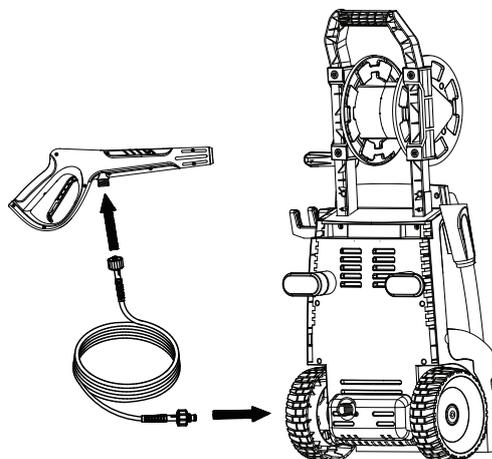
Attachez le tuyau à haute pression au pistolet et à la sortie d'eau de la machine (serrez à la main seulement).
