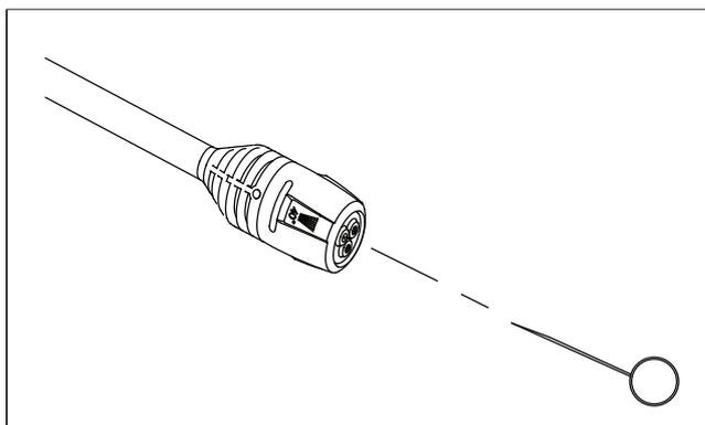
L'obstruction des buses peut entraîner une pression trop élevée dans la pompe, et il faut alors les nettoyer immédiatement. Vous pouvez nettoyer les buses en insérant doucement une aiguille, ou un objet mince et pointu (p.ex., un trombone) dans le bout pour déloger les dépôts.
