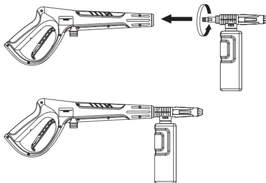
1. Fixez le pistolet à mousse sur le pistolet de pulvérisation.
