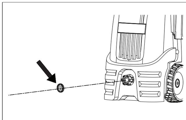
Le pulvérisateur haute pression est muni d'un filtre d'entrée d'eau pour protéger la pompe. Gardez le filtre propre pour prévenir la réduction du débit d'eau du pulvérisateur haute pression et les dommages à la pompe.
