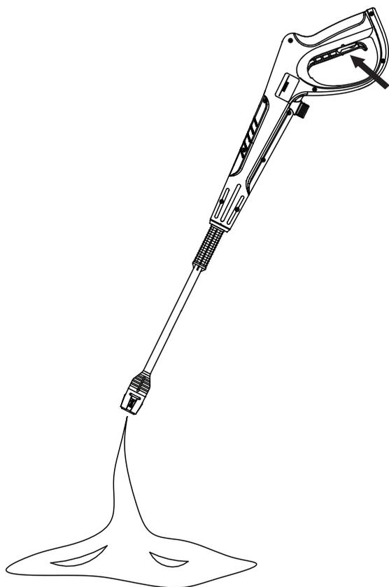
Purgez l'air de l'appareil en appuyant sur la détente du pistolet jusqu'à ce qu'il y a un jet d'eau régulier.
