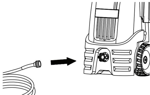
Connectez le tuyau d'arrosage à l'adaptateur du raccord d'entrée.
