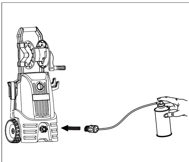
1. Raccordez le boyau du contenant d'antigel à l'adaptateur d'orifice d'admission.
