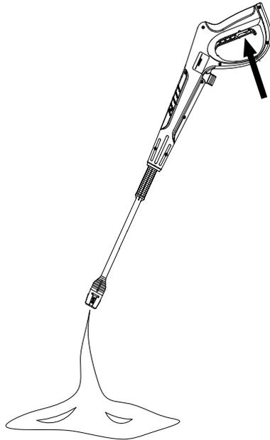
Purgez l'air de l'appareil en appuyant sur la détente du pistolet jusqu'à ce qu'il y a un jet d'eau régulier.
